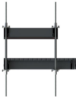
3D-модель разрез сборки универсального щита и линейного щита
