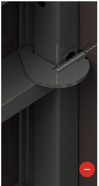
Анкер торцевой пересекается с втулкой под тяжи
