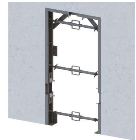
Демонтаж изделия заключается в расслаблении фиксирующих гаек и стягивания стенок боковыми подкосами (упорами). После этого изделие легко отходит от бетона.
