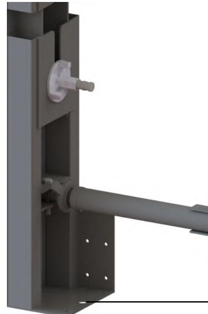
Чтобы компенсировать боковое давление бетона на проемообразователь, нужно **ПРАВИЛЬНО УСТАНОВИТЬ ПОДКОСЫ (УПОРЫ) — В ГОРИЗОНТАЛЬНОЕ ПОЛОЖЕНИЕ**
